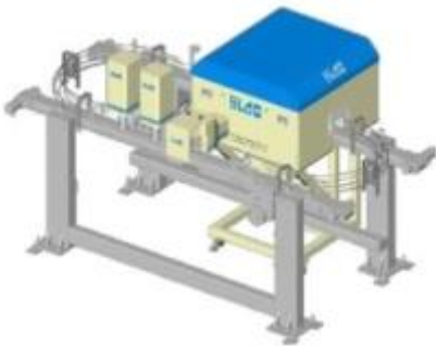
易拉罐检测设备
